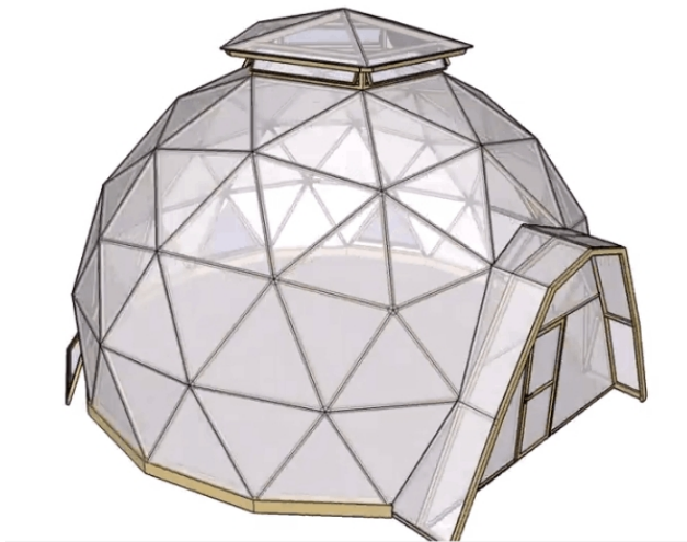
Imagem 17 – Exemplo de domo geodésico com lanternim no topo e beiral.
